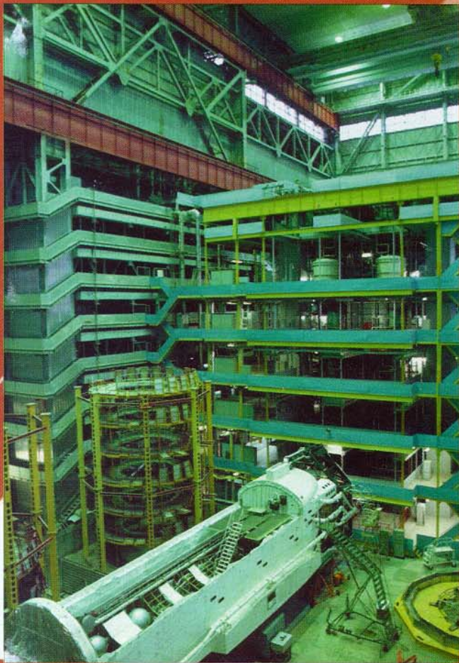
Средняя часть фюзеляжа ОК "Буран" на технической позиции Fuselage middle of BURAN spaceship in the engineering position
