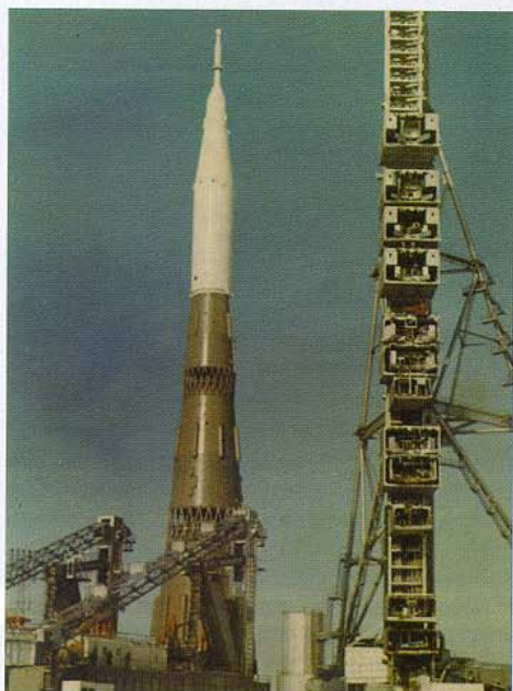
Ракета-носитель Н1, двигатели которой испытаны в НИИХИММАШ
