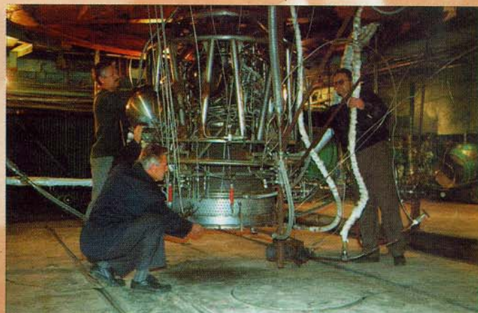
Подготовка к испытаниям ЖРД на метановом горючем Preparation of liquid rocket engine on methane fuel for testing
