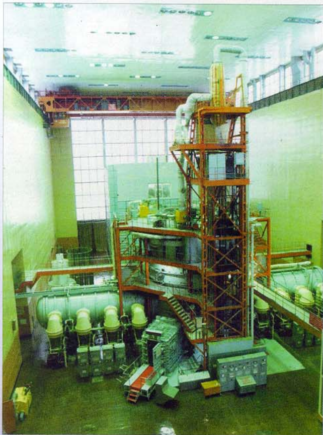
Камера для термовакуумных испытаний КА VK600/300 Chamber VK600/300 for thermovacuum testing Space Vehicle
