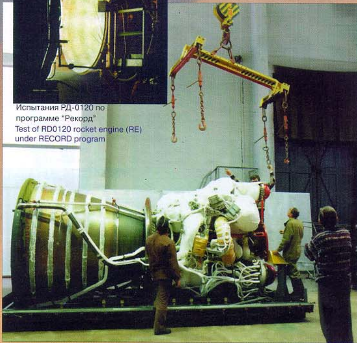
Двигатель РД-0120 в монтажно-испытательном корпусе RD0120 RE in the assembly-test building
