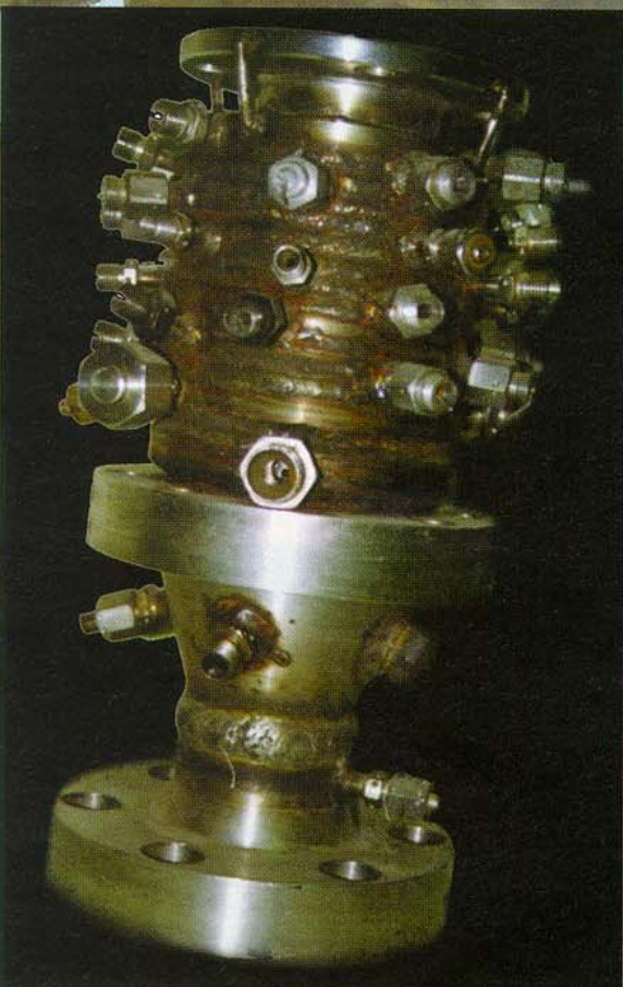
Экспериментальная камера сгорания ЖРД с транспирационным охлаждением Experimental combustion chamber of LRE with transpiration cooling
