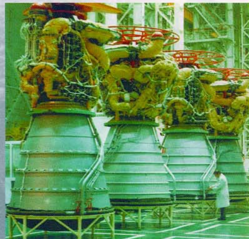
Двигатели РД-120 для РН "Энергия", испытанные в НИИХИММАШ Engines "RD-102" for launcher-vehicle ENERGIA tested at NIICHIMMASH
